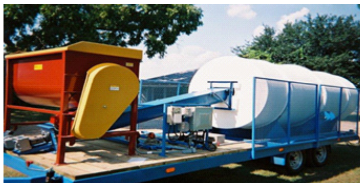
Фиг. 4. Примерна мобилна система за активирано компостиране в затворен реактор Fig. 4. An example of mobile system for activated composting in closed reactor
