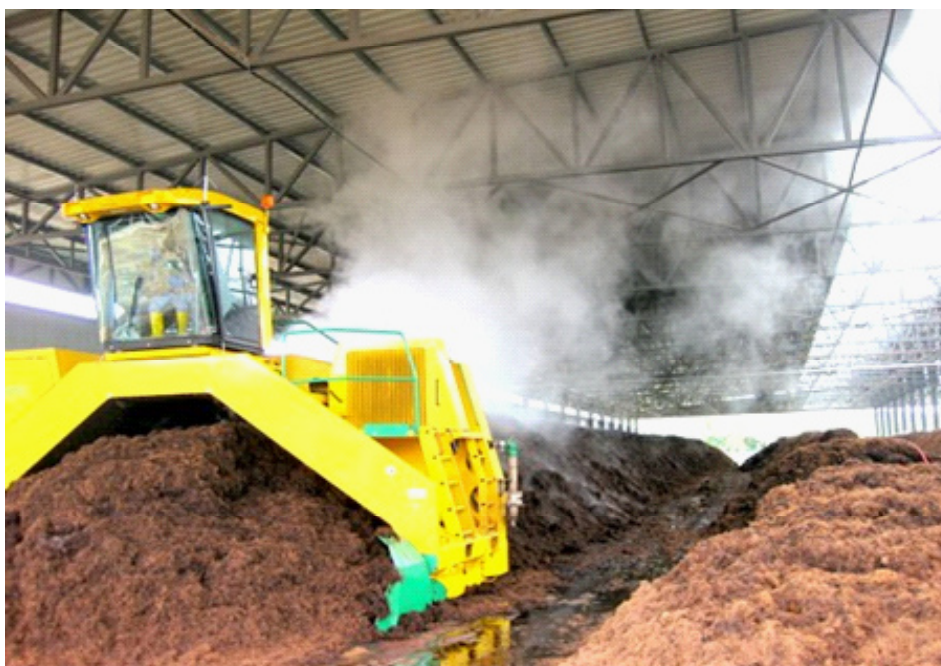
Фиг. 6. Индустриално аеробно компостиране на отпадъци от плодовете на палми при тропични условия
