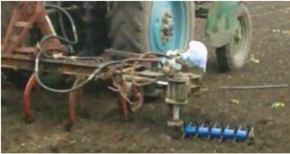
Рис. 6. Усовершенствованный садовый культиватор КСГ-5 с бороной садовой Fig. 6. Improved orchard cultivator KSG-5 with a orchardharrow
