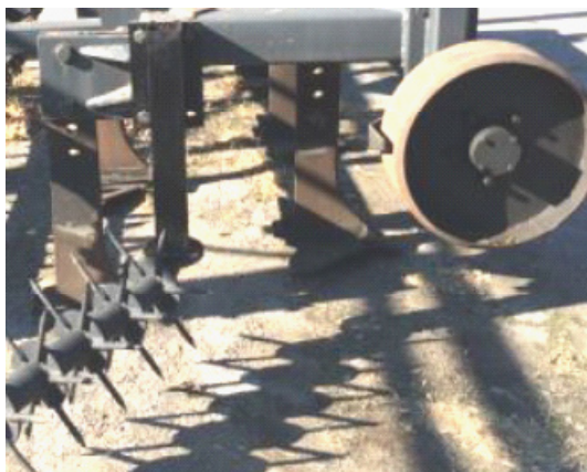
Рис. 4. Чизель ЧСВ-3,2 с бороной садовой Fig. 4. Chisel CHSV-3.2 with a orchardharrow
