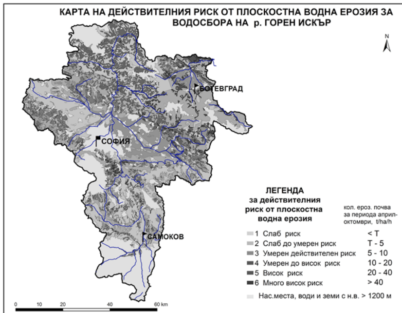
Фиг. 3. Карта на действителния риск от плоскостна водна ерозия за водосбора на р. Горен Искър Fig. 3. Map of actual risk of sheet water erosion of soil for the Upper Iskar River catchment
